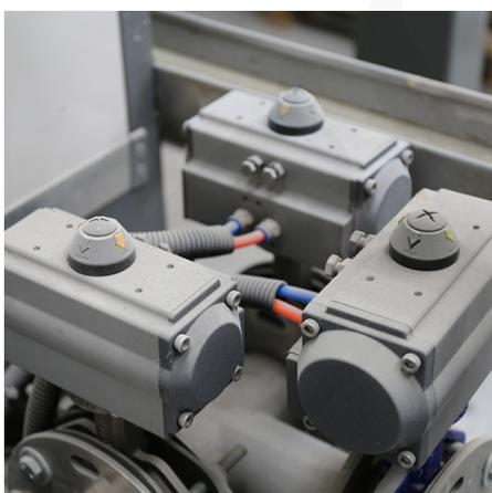
**Les débits des pompes sont réglés manuellement par des vannes papillon, en option avec des inverseurs inverseurs**
